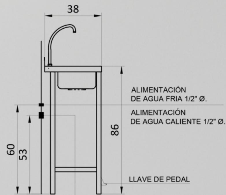
DESAGUE AL MURO, CAÑERÍA DE 1 1/2" Ø.
